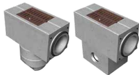
Entwässerungsschacht – mit verriegelbarem Gussrost, Baulänge 1,01 m, zum Anschluss des Rinnensystems an die Entwässerungsleitungen. Standardbauteil in Kombination mit Straßenablaufteilen nach DIN 4052, bedarfsbezogene Sonderanfertigung als monolithischer Schacht.
