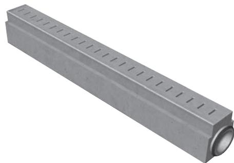
Entwässerungsschacht – Standardbauteil, mit verriegelbarem Gussrost, Baulänge 1,01 m, zum Anschluss des Rinnensystems an die Entwässerungsleitungen über Straßenablaufbauteile nach DIN 4052. Anschlussmuffe KG DN 150 / 200 / 300 (je nach Bedarf).
