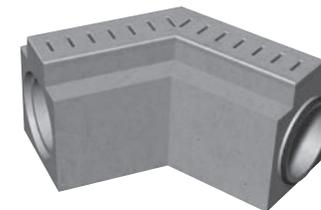
T-Stück – bedarfsbezogene Sonderanfertigung, Baulänge und Anschlusswinkel variabel, (soweit geometrisch möglich) zum Anschluss eines Stranges an einen quer verlaufenden Strang, Geometrie wie Normalrinne.
