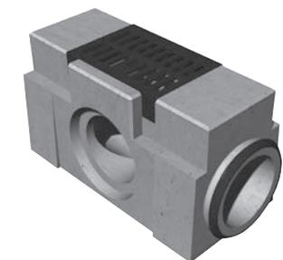
Reinigungsrinne – Standardbauteil, mit verriegelbarem Gussrost, Baulänge 1,01 m, als Reinigungszugang zum Gerinne.
