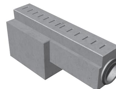
Böschungsstück – bedarfsbezogene Sonderanfertigung, Baulänge variabel, als Auslauf in Becken und Mulden, auch in Verbindung mit Winkelstück möglich, Geometrie wie Normalrinne.
