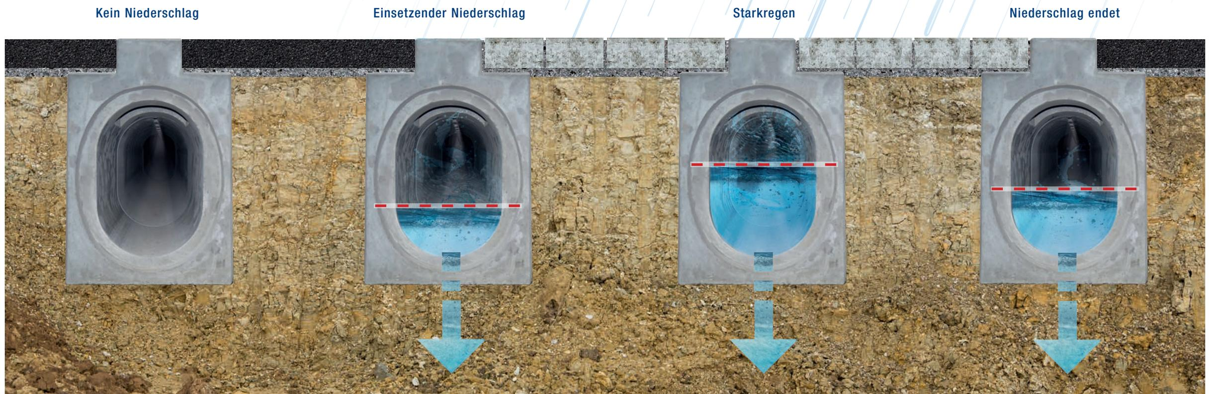
Niederschlagswasser gelangt von der Oberfläche in die Rinne. Durch die ovale Geometrie des Querschnitts bei den größeren Profilen werden auch schwache Niederschläge zügig abgeleitet.
